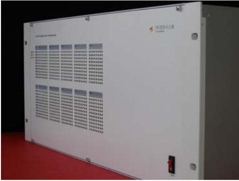
JY4102DA High Density Switching Frame은 최대 10개의 Switching Card를 삽입할 수 있는 slot을 갖고 있으면 최대 800채널의 접점을 제어할 수 있다. GPIB를 통하여 각각 카드의 접점을 제어하여 테스트를 최선의 상태로 자동화 프로그램할 수 있도록 도와 줍니다. 특히 Matrix-Card를 사용할 경우 소수의 측정 Device를 여러 개의 측정 Sample에 연결할 수 있어 복잡한 외부의 배선을 줄여줄 뿐 아니라 측정 Device의 수를 줄여서 경비절감을 할 수 있습니다. JY4102DA는 내부에 냉각팬을 사용하지 않아서 팬에 의한 소음이나 오염을 줄여주고 외부 오염원과 차단되어 크린룸 사용에 적합합니다.
