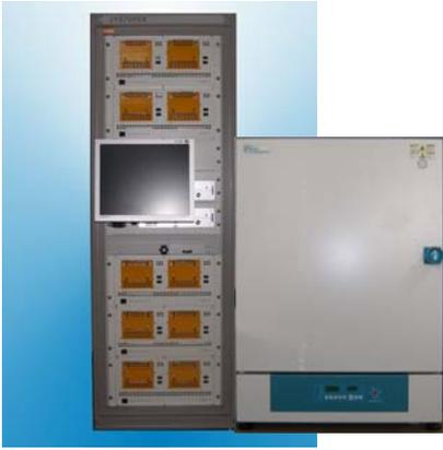
JYS702SB는 JY7202SA를 5대와 computer를 19" 표준 Rack에 장착한 제품으로 최대 110개의 고휘도 LED를 측정할 수 있습니다. JY7202SB는 온 습도를 조절할 수 있는 챔버에서 고휘도 LED의 전기적 특성을 측정할 수 있도록 고안된 시스템입니다. 챔버내에는 11개의 시료를 block별로 측정할 수 있는 JIG 10개를 측정할 수 있습니다.
