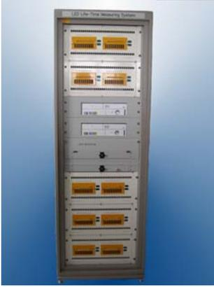
JYS701SA는 JY7201SA를 5대와 computer를 19" 표준 Rack에 장착한 제품으로 최대 100개의 고휘도 LED를 측정할 수 있습니다. JY7201SA는 2개의 온도 조절 block으로 나누어 짐으로 JYS701SA는 10대의 오븐에서 고휘도 LED 100개를 측정할 수 효과를 얻습니다. All in One 시스템으로 19" 표준 Rack 크기에 별도의 장비가 추가 되지 않아서 측정을 위하여 적은 공간만 사용합니다.
