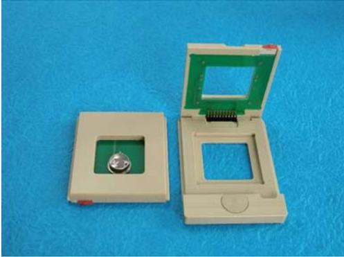
Cartridge 방식의 수명측정 JIG는 매우 얇은 두께임에도 불구하고 시료의 탈.장착이 매우 쉽게 되어 있습니다. JIG 윗면과 아래면에 빛 방출구를 만들어서 Pad의 위치가 빛 방출면과 관계없이 사용할 수 있습니다. 수명측정 JIG는 외부에서 시료 검사 시에도 간편하게 전원을 ON/OFF 할 수 있으며 현미경 관찰 시에도 편리하게 사용할 수 있습니다. 모든 Pad contact은 Pogo Pin을 사용하여 고온에서도 안정적인 접점을 얻습니다. Pad의 위치는 PCB 기판을 사용하기 때문에 시료의 빛 방출면에 영향을 받지 않습니다. 휘도 측정은 Photo diode, RGB sensor등을 사용자 선택에 따라 측정에 사용할 수 있습니다.
