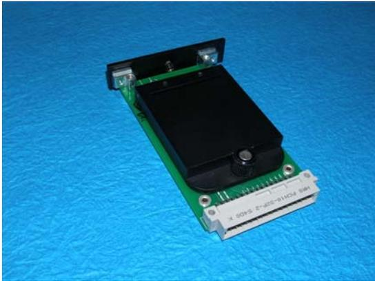
Sub-rack 방식의 수명 측정 JIG는 저렴한 가격이며서 얇은 두께로 시료의 탈·장착이 매우 쉽게 되어 있습니다. PD는 JIG 윗 면에 뚜껑에 설치되어 있습니다. Pad의 위치는 PCB 기판을 사용하기 때문에 시료의 빛 방출면에 영향을 받지 않습니다. 모든 Pad contact은 Pogo Pin을 사용하여 고온에서도 안정적인 접점을 얻습니다. 휘도 측정은 Photo diode, RGB sensor등을 사용자 선택에 따라 측정에 사용할 수 있습니다.
